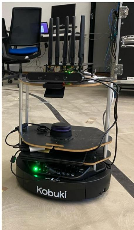
Fig. 6.1. Turtlebot equipado con una cámara RGB, un módulo de conexión cliente de WiFi y un LIDAR para el posicionamiento
